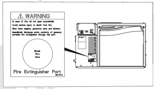
FIGURE 12. FIRE EXTINGUISHER PORT LABEL LOCATION
