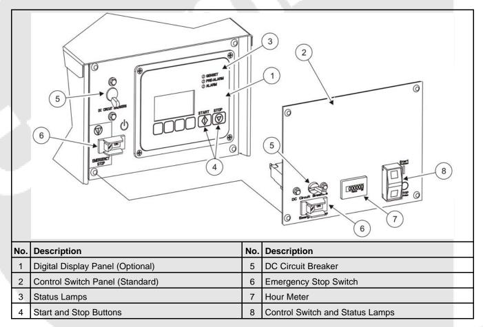
FIGURE 4. LOCAL CONTROL PANEL COMPONENTS
