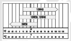
FIGURE 17. OIL VISCOSITY VS. AMBIENT TEMPERATURE
