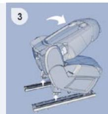
3. Abata el respaldo en el cojín del asiento y acompañe el movimiento del respaldo hacia delante hasta desbloquear las patas traseras. En caso de dificultad, utilice el mando de emergencia para desbloquear las patas.
