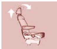
5. En altura y en inclinación del reposacabezas.
