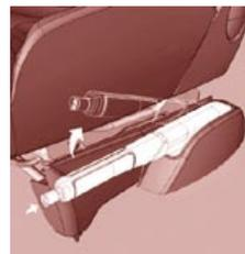
Si su vehículo está equipado con una versión con asiento delantero pivotante, tire hacia delante del botón que está en el extremo del freno de estacionamiento.
