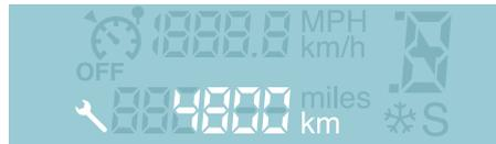
Unos segundos después de poner el contacto, sale señalado el nivel de aceite, y el totalizador kilométrico recobra su funcionamiento indicando el kilometraje total y parcial.
