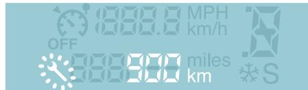
Unos segundos después de poner el contacto, sale señalado el nivel de aceite, y el totalizador kilométrico recobra su funcionamiento normal y la llave se queda encendida. Le señala que debe realizar próximamente una revisión.
