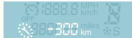
**i** Motor en marcha, la llave se queda encendida hasta que se efectúe la revisión.
