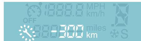
**i** Motor en marcha, la llave se queda encendida hasta que se efectúe la revisión.
