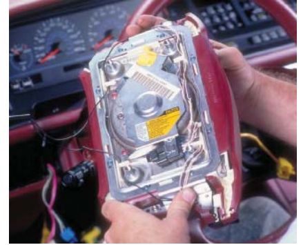
P29-12 Remove the module.
