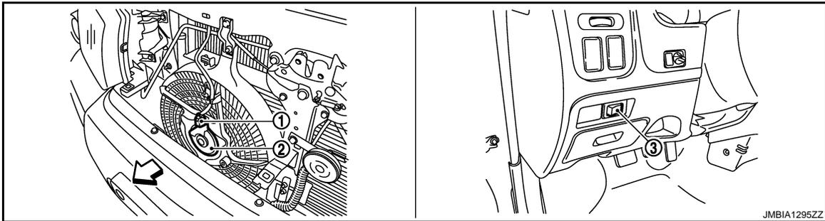
1. Cooling fan motor connector
